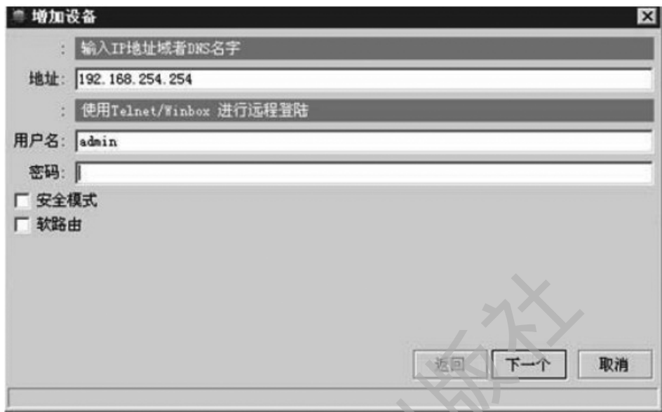
图 2-14 输入添加设备的 IP 地址
